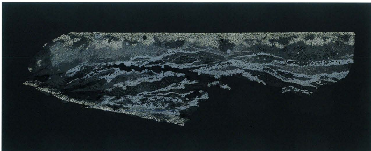
図2 椿井大塚山古墳出土T21鏡の断面観察（光学顕微鏡）（すべてサビに変質し、健全な金属組織は失われている）
